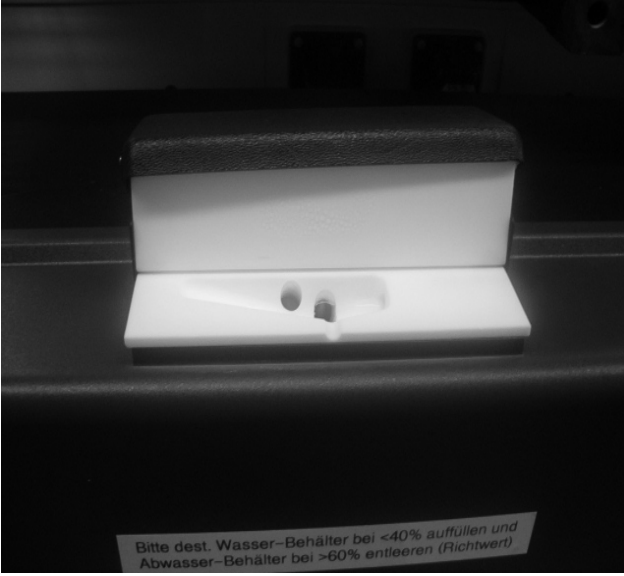
Şekil 4. Coulter Cihazı; mikrokapsül dispersiyonu cihazın üzerinde bulunan deliklerin içerisine yerleştirilir
