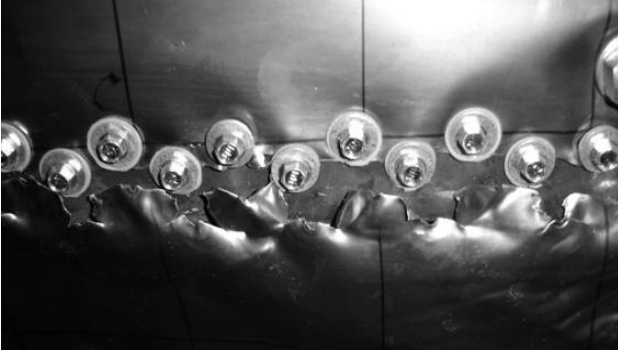
Şekil 14. Levha üst kuzey köşesinde yırtılma (çevrim:33, tepe yer değ.: -50.39mm)
