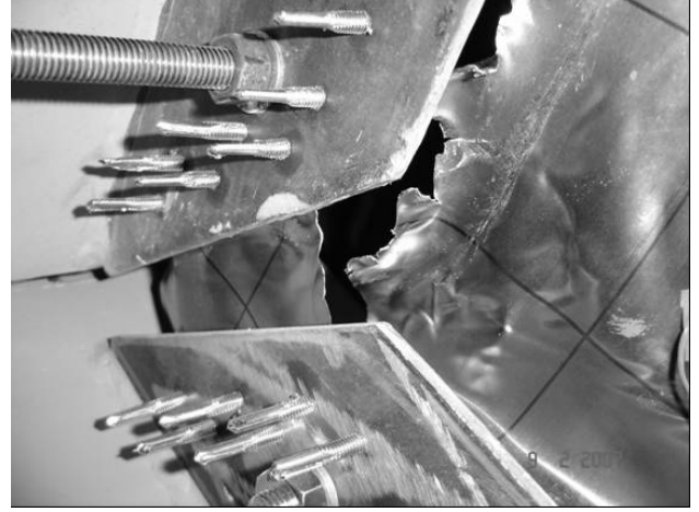
Şekil 16. Levha üst kuzey köşesinde yırtılarak ayrılma (çevrim:34, tepe yer değ.: -58.80mm)
