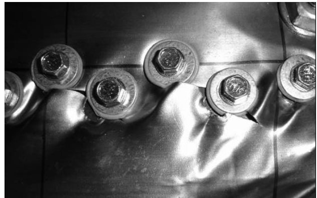
Şekil 13. Levha üst kuzey köşesinde yırtılma (çevrim:32, tepe yer değ.:+50.39mm)
