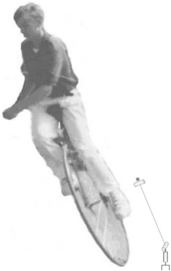
Şekil 8. Monosiklet ve onun sembolik gösterilimi
