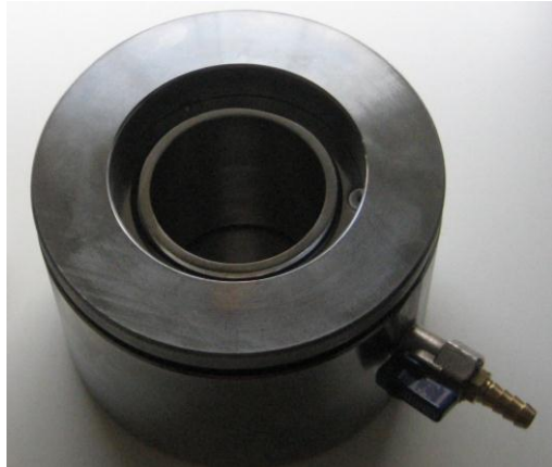
Şekil 5. Ödometre halkasının ters basınç hücre sine yerleşmiş ve hücrenin izole edilmiş hali
