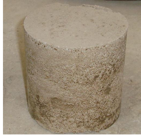
Şekil 7. Kompakte edilmiş silindirik kil numune
