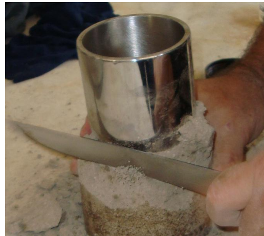
Şekil 8. Numune alıcı tüp ile kompakte edilmiş silindirden numune alınması sırasında çekilen bir fotoğraf
