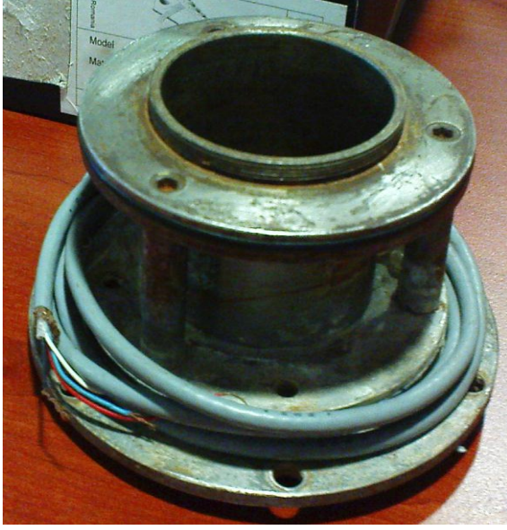
Şekil 1. Ertekin (1991) tarafından üretilen ve örnek olarak yararlanılan ince cidarlı hücre
