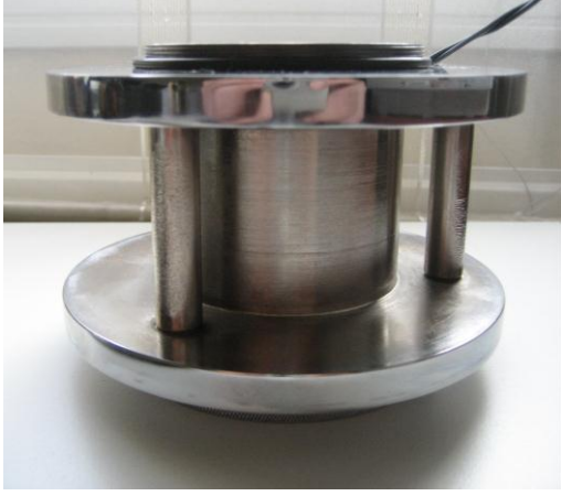
Şekil 3. Yeniden üretilen ve geliştirilen ince cidarlı yanal şişme basıncı hücresi
